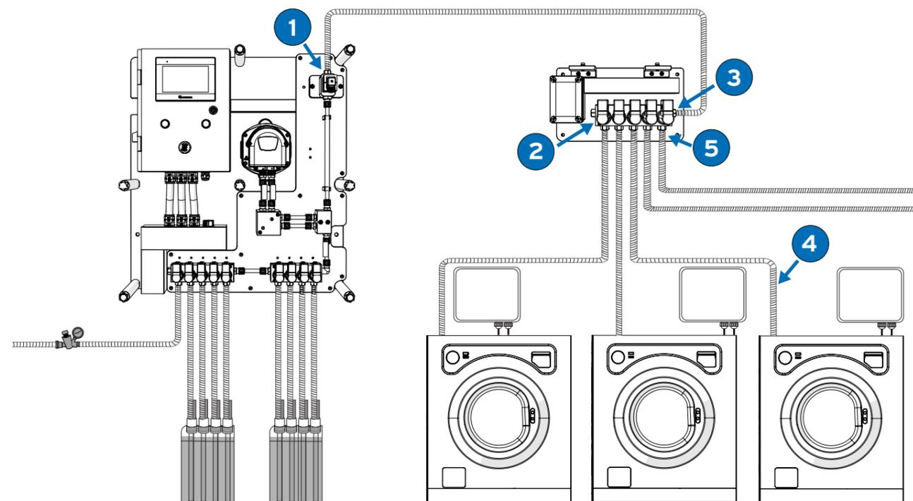
Para conectar el equipo, el distribuidor y las arandelas, utilice tubo de PVC reforzado 10x16 y abrazaderas de acero inoxidable.
