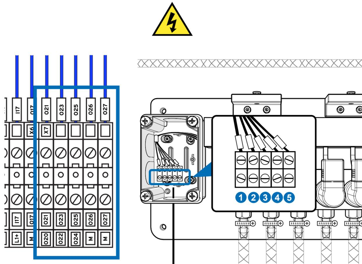
Utilice un cable de  $7 \times 1 \text{mm}^2$  para la conexión entre la cabina de control y el distribuidor. Conecte el distribuidor al bloque de terminales X7. Cada conexión de terminal corresponde a las salidas numeradas de izquierda a derecha, dependiendo del orden del orden. A continuación se muestra el esquema eléctrico de el equipo principal.
