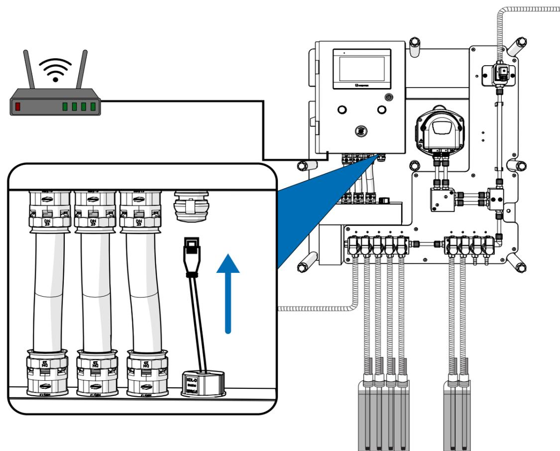
Para conectar el equipo a Internet, basta con enchufar un cable Ethernet a cualquier router a través del conector situado en la parte inferior de la caja principal.
