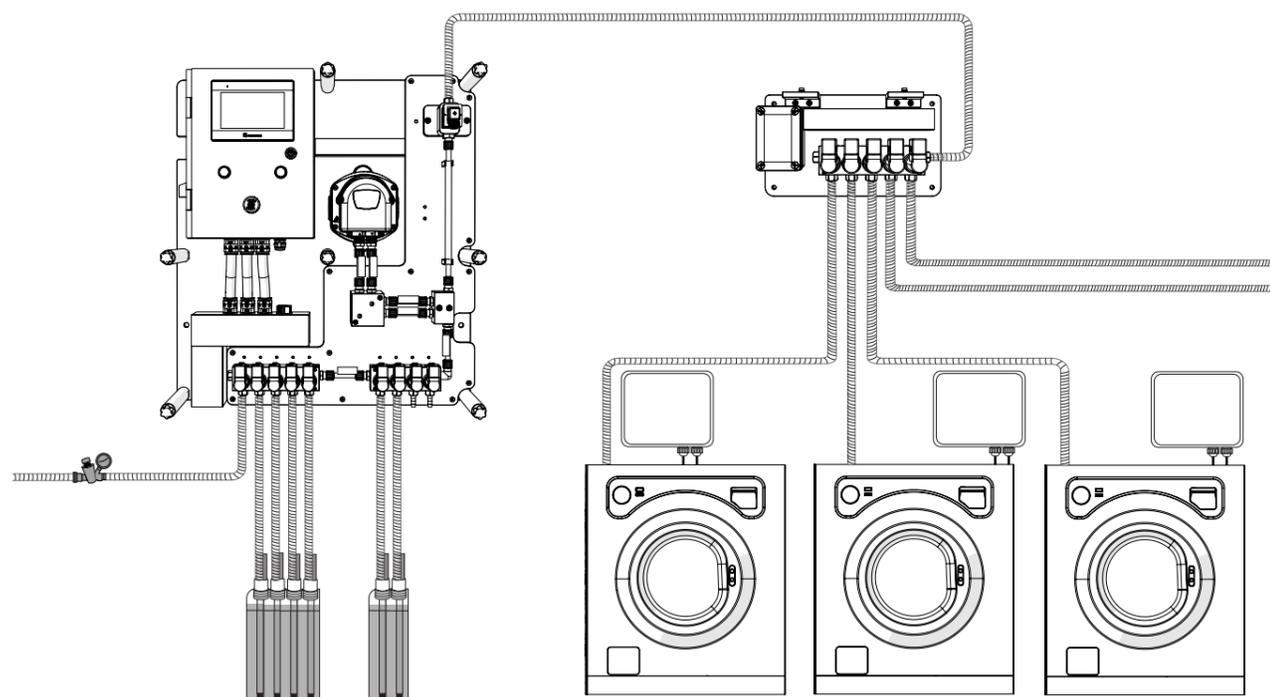
Esta imagen reproduce la configuración "Estándar" de un equipo Multiplex con un canal, entendiéndose por "Canal" un grupo de productos que se inyectan en el mismo colector y se dirigen a un distribuidor (lavadoras) o a una inyección (túnel).
