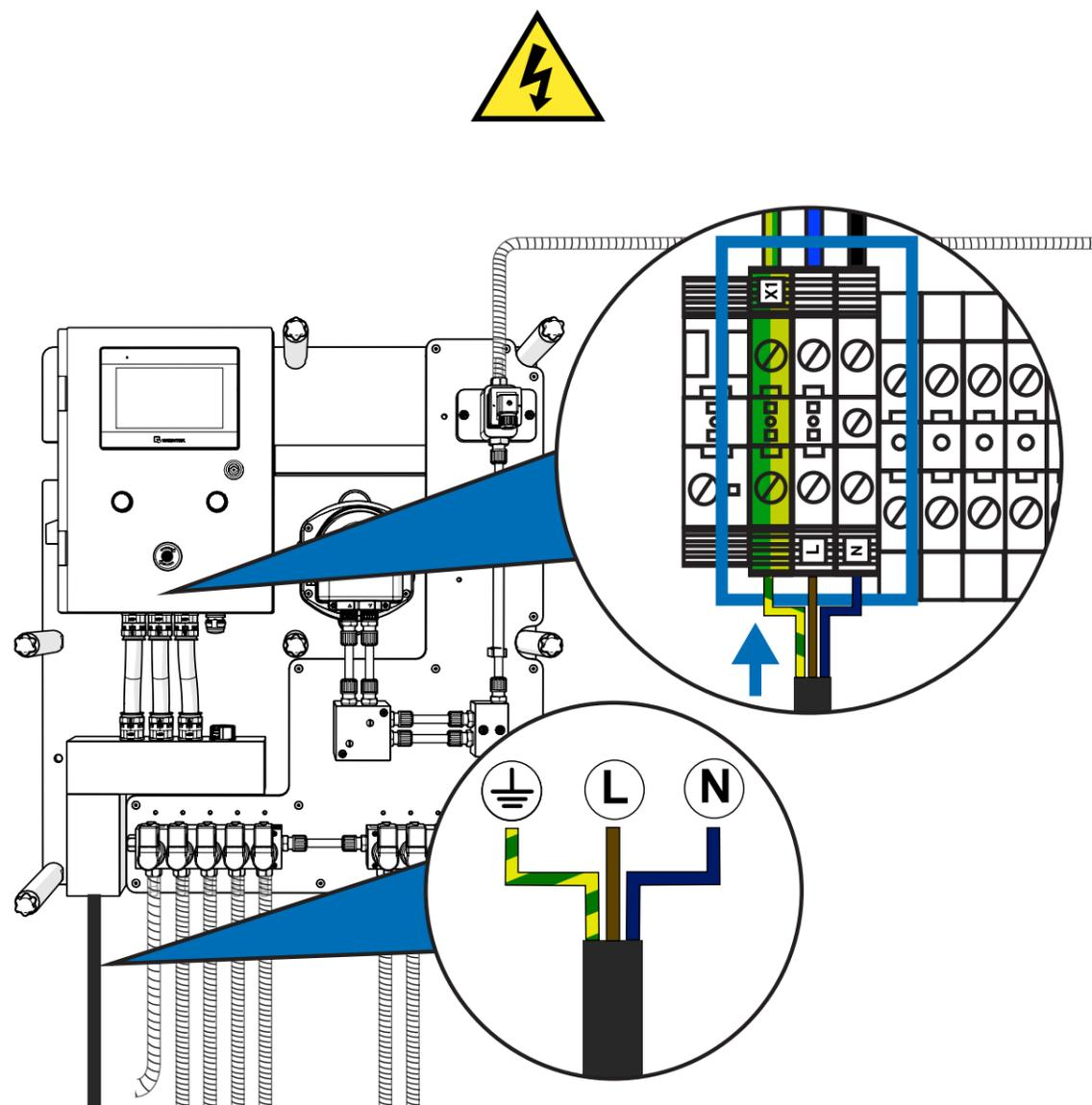
Para la alimentación del equipo debe utilizar cable de **3x1'5mm<sup>2</sup>**. Introduzca el cable por el canal situado en la parte inferior izquierda y utilice uno de los prensaestopas para introducirlo de forma segura en el interior del armario eléctrico. Conéctelo a los bornes identificados con **X1** que se encuentran en la parte inferior izquierda de las conexiones. Para garantizar la correcta protección. Utilice una línea específica para la alimentación del equipo.
