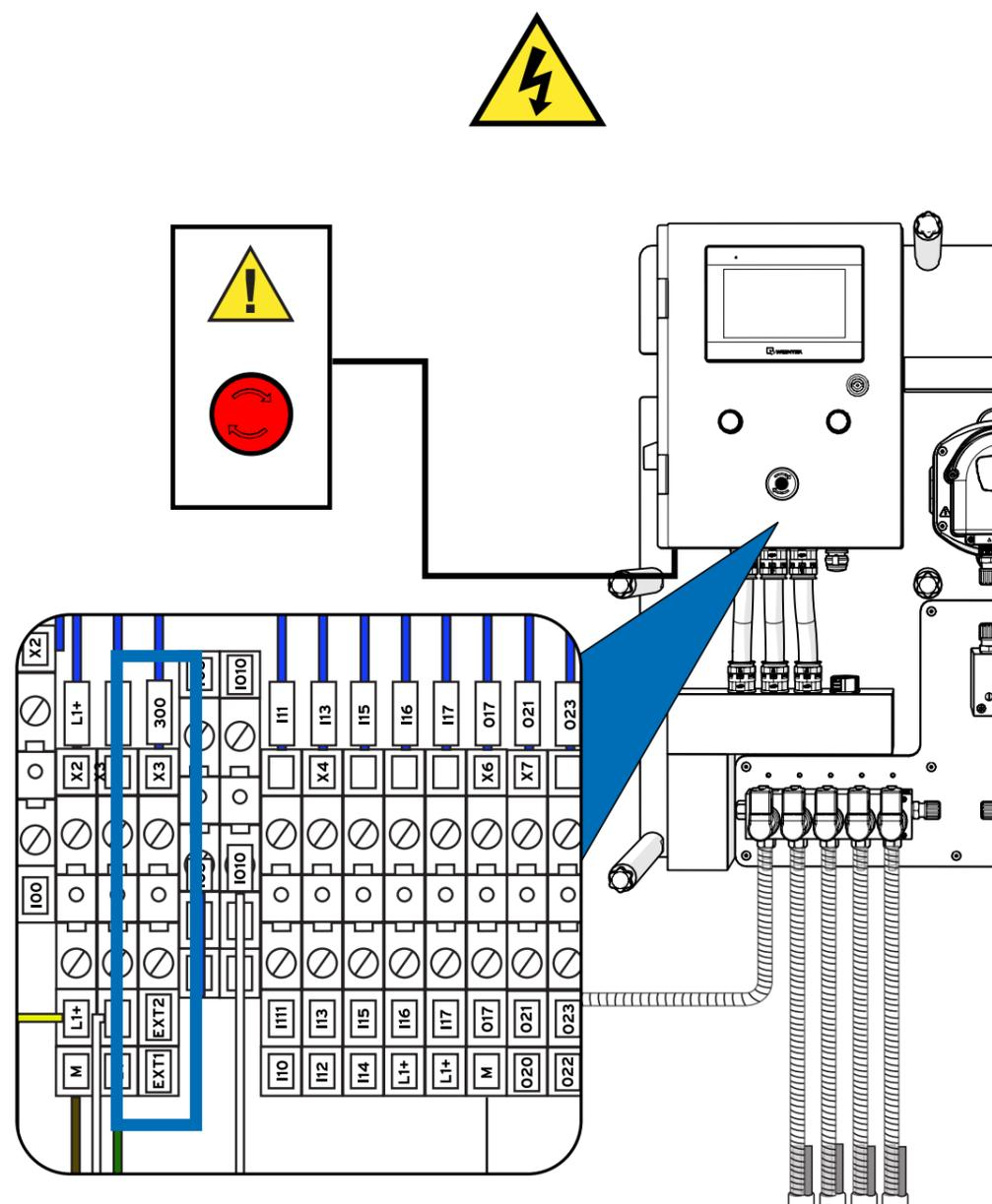
Para conectar un botón de parada de emergencia a su equipo, puede utilizar la ranura de los conectores **EXT1** y **EXT2** que se muestra arriba en serie.
